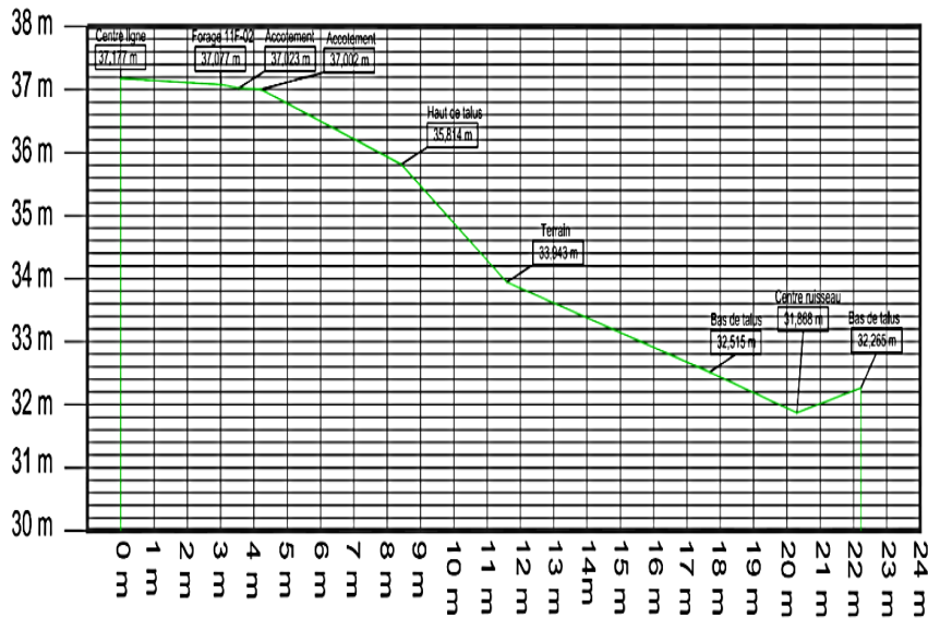
Fig. 10. Géométrie du talus au niveau de la section B.
